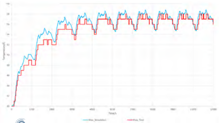
Ce graphique montre que les données de la simulation thermique correspondent étroitement aux données expérimentales, avec une marge d'erreur de seulement 5 %.
